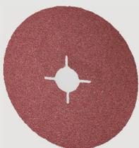
Halboffen gestreutes Keramikkorn-Schleifmittel mit Selbstschärfungseffekt. Überzeugt bei der Bearbeitung sehr harter Oberflächen, wie unlegiertem Stahl oder Edelstahl, durch einen aggressiven Schliff und sehr lange Standzeiten.
