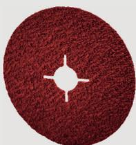
Medium geschlossen gestreutes mikrokristallines Keramikkorn-Schleifmittel mit verbessertem Selbstschärfungseffekt für mittlere bis hohe Andrücke. Optimiert für die Bearbeitung von Superlegierungen, Edelstählen oder Aluminium. Überzeugt durch einen aggressiven aber kühlen Schliff bei sehr langen Standzeiten. Die schleifaktive Zusatzschicht TOP SIZE reduziert zudem die Temperatur in der Schleifzone.
