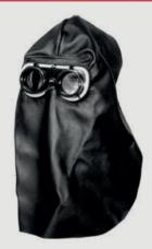
Lederhaube für Zwangslagenschweißen, rundherum geschlossen, Schutzbrille mit Hochklappteil (Sichtscheiben 90), für Glasgröße 50 mm Ø, außenanliegende Belüftungsventile
