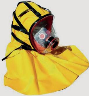
Atemmaske mit Gesichtsabdichtung aus Silikonkautschuk, mit FDA-Zulassung. Gewindeanschluss nach EN 148-1, universell bei allen Atemschutzgeräten. Gesichtsstück aus Silikon. Das Visier ist beschlagfrei durch die Steuerung der Kalt- und Warmluftströmungen innerhalb der Maske. Die optische Klasse 1 (EN 166) erlaubt ein Panoramasisichtfeld ohne optische Verzerrungen. Die Atemmaske bietet maximalen Tragekomfort durch die Befestigung per 6-Punkte Gurt.
