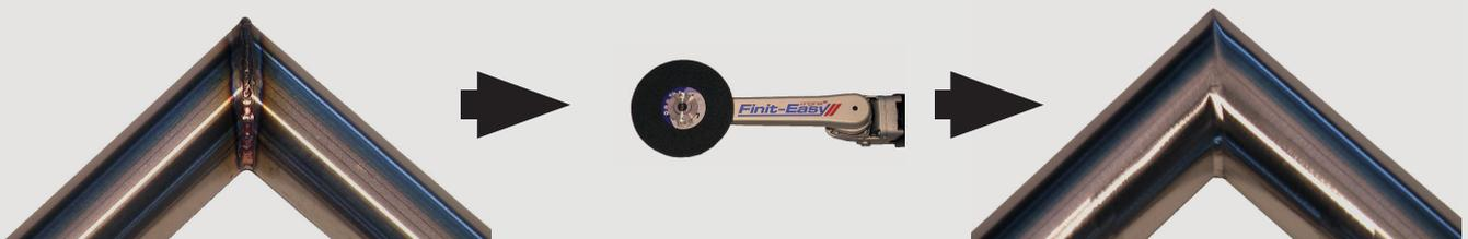
Mit der **SA 8- Scheibe** 3,0 mm (Seite 238), in nur einem Arbeitsgang die Anlaufarben der Kehlnaht entfernen, die Schweißraupen glätten und ein 240er Schliifband erstellen (empfohlener Drehzahlbereich: Stufe 3).
