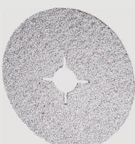
Die neue Zusatzschicht STEARAT Plus verringert die Anhaftung des Materials am Schleifkorn deutlich. XF733 ist ein halboffen gestreutes Keramikkorn-Schleifmittel mit Selbstschärfungseffekt. Es überzeugt bei der Bearbeitung von NE-Metallen – insbesondere Aluminium – durch einen aggressiven Schliff und sehr lange Standzeiten.
