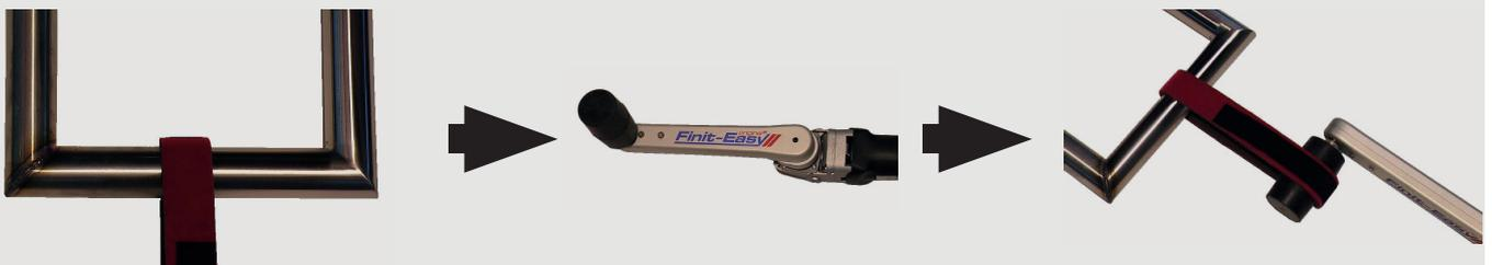
Mit Hilfe der **Vulcolan Antriebswalze** (Seite 229) und den wiederverschließbaren Vliesbändern kann man schnellstens einen Rohrbandschliff erstellen (empfohlener Drehzahlbereich: Stufe 1).
