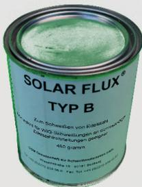
Für alle ferritischen und austenitischen Stähle mit weniger als 25% Nickelanteil. Einsetzbar bei Autogen-, Anlagen- und WIG-Schweißungen. Verhindert Oxidationseinschlüsse und schützt die Rückseite der Schweißnaht vor Oxidation. Solar Flux wird mit Alkohol, vorzugsweise Methanol oder auch destilliertes Wasser zu einer gebrauchsfertigen Masse gemischt. Wir weisen darauf hin, dass es sich um ein Hilfsmittel für untergeordnete Schweißarbeiten handelt.
